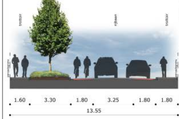
Baarskampstraat | Dwarsprofiel AA | Nieuwe situatie | Schaal 1:50
