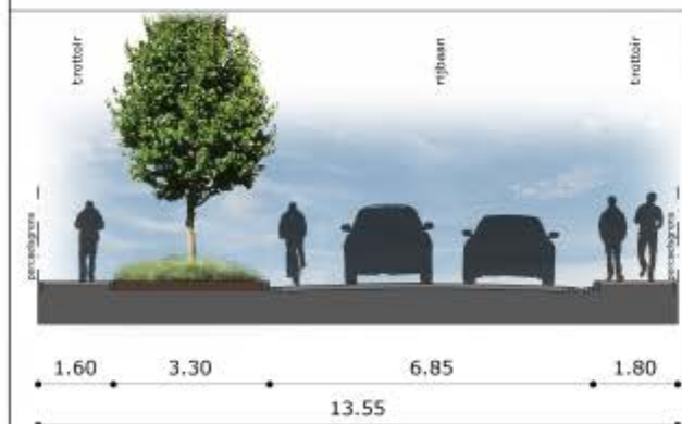
Baarskampstraat | Dwarsprofiel AA | Bestaande situatie | Schaal 1:50
