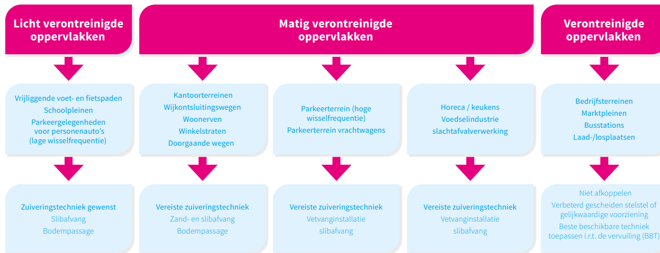
Afbeelding 7 Zuiveringstechnieken bij verschillende verontreinigde oppervlaktes
